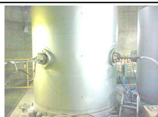
煙突における排ガス測定の様子です。
