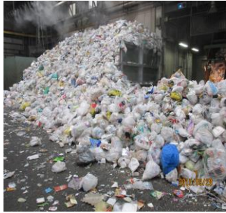
プラットホーム 収集車で搬入された不燃ごみ、プラスチック類を受け入れます。
